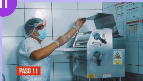
Cierra la compuerta del equipo, ajusta los dos tornillos de la parte frontal del equipo.
