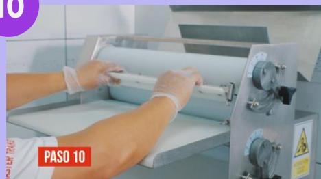
Coloca las cuchillas de los rodillos al equipo.
