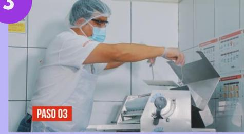
Con la escalera de tres pasos retira la cuchilla de la parte superior trasera del equipo, cuchilla delantera superior y cuchilla inferior delantera. Lléalas a la poza de lavado.
