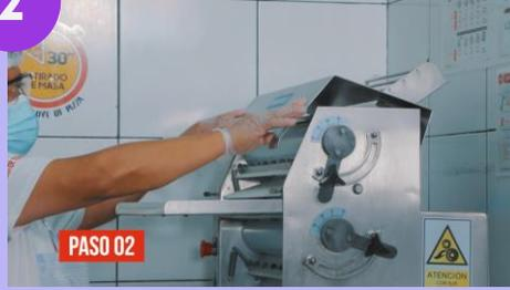
Afloja los tornillos de la parte frontal del equipo y levanta hacia atrás la compuerta del equipo
