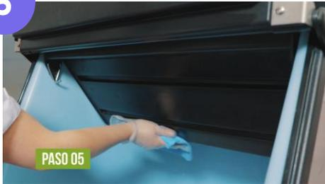
Limpia el borde y superficie del deflector con un paño de limpieza azul con sanitizante. Levanta la tapa para limpiar las esquinas.
