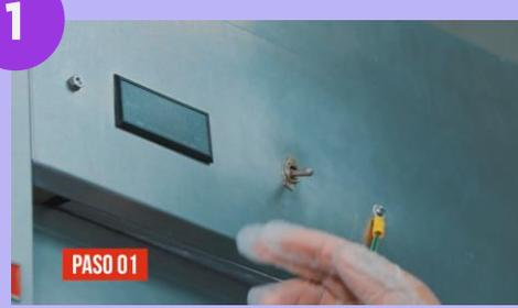
Apaga el equipo con la palanca del equipo y la llave del tablero.
