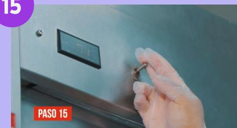
Enciende el equipo con la palanca del equipo y con la llave del tablero.
