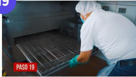
Con la ayuda de otra persona, coloca el catre en el equipo. Coloca la cadena. Encaja cada extremo de la cadena. Encaja y presiona el catre hacia abajo.
