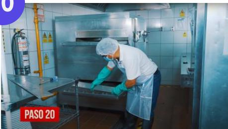
Coloca las bandejas en ambos lados. Coloca el tope al equipo usando un desarmador. Coloca las pestañas en el equipo. El tornillo van en la ranura número tres del equipo para ambos lados de las pestañas y del horno.
