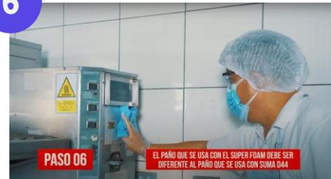
Limpia el panel de control y la parte externa superior del equipo con un paño azul seco. Limpia toda acumulación y suciedad frotando con la yema de los dedos.
