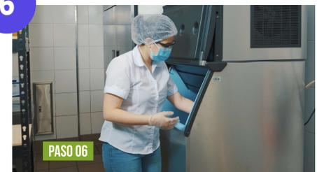
Limpia la parte interna de las paredes de la máquina con un paño con sanitizante.
