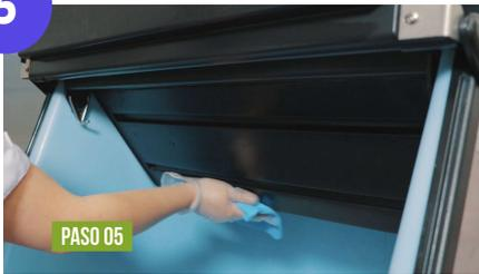
Limpia el borde y superficie del deflector con un paño de limpieza con sanitizante. Levanta la tapa para limpiar las esquinas.
