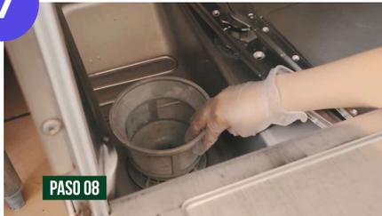
Coloca el colador pequeño en el equipo, coloca la parrilla del filtro y cierra la tapa del equipo. El bastidor de platos se quedará fuera hasta iniciar el proceso de lavado.
