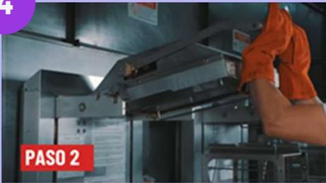
Retira canasta de pollo, desconecta el equipo y levanta la tapa colcando el seguro.
