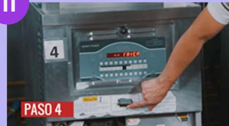
Sin los guantes, conecta el equipo. Presiona el modo bomba, deja el aceite refinar mínimo 15 minutos, cierra la válvula de drenaje y valida que el aceite suba completamente.
