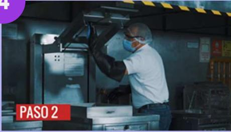
Levanta la tapa, coloca el seguro, cambia tus guantes por los de calor para limpieza, limpia la tapa y agarradera con desengrasante, enjuaga con agua y un trapo azul y luego sanitiza con agua sanitizante y un trapo azul.
