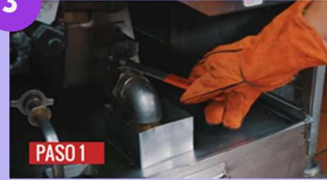
Con los guantes de calor y el equipo completamente frío, abre la válvula de drenaje. Cuando haya drenado todo cierra, desenrosca el tubo de drenaje y retira el carrito.
