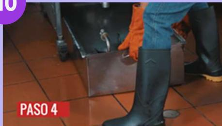
Con los guantes de calor, coloca el carrito en posición inicial, enrosca el tubo y abre la válvula.
