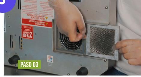
Gira el equipo cuidadosamente por la parte de la base del equipo y retira ambos filtros.
