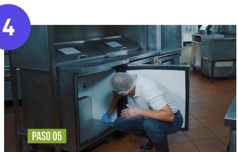
Limpia la parte interna del equipo, paredes internas y base interna del equipo con agua sanitizante y un paño húmedo verde.
