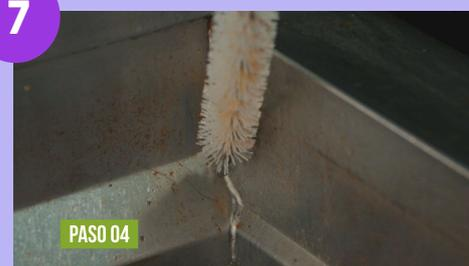
Espera a que el agua llegue ebullición. Refriega frecuentemente con una esponjilla o escobilla de teflón los lados e interior de freidora.
