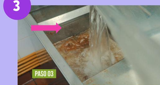
Con la tina vacía, agrega agua caliente y entre 1 y 2 tazas de bicarbonato. La línea inferior es el límite de llenado.
